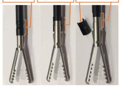
Le tube thermorétractable reste d'un seul tenant, mais il apparaît qu'une partie longitudinale est manquante. Ceci est dû au fait que, après s'être fendu, sa taille rétrécit pour exposer une partie de l'embout métallique (voir l'illustration). Si une fente se produit, la tubulure thermorétractable peut se détacher du dispositif avant ou au cours d'une intervention et, si une cautérisation est nécessaire, il existe un risque de brûlure suite au défaut d'isolation.
