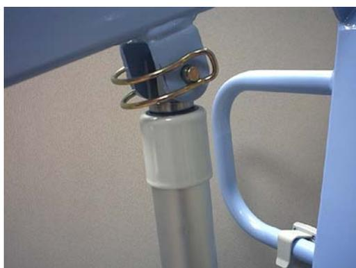
\* Etape 3 : Retirer le capuchon noir, dévisser l'écrou stop, retirer les rondelles, retirer la vis.
