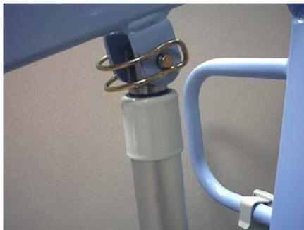
\* Etape 7 : installer le fléau (mis de coté à l'étape 1) grâce à la pièce 10, ainsi que la vis et l'écrou 8.
