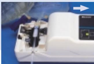
**10.-** A la fin du cycle de décontamination, ouvrir le boîtier à fond jusqu'à la butée.
