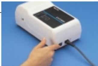
**2.-** Mettre sous tension l'appareil UV-Flash™ Compact.
