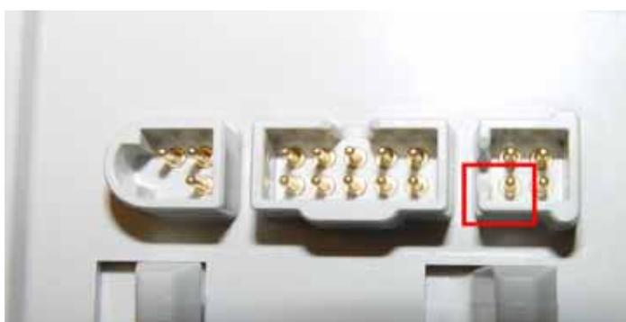
**3. Résultats :** noter le résultat sur le formulaire joint. La batterie est conforme si le circuit est ouvert (résistance mesurée infinie).
