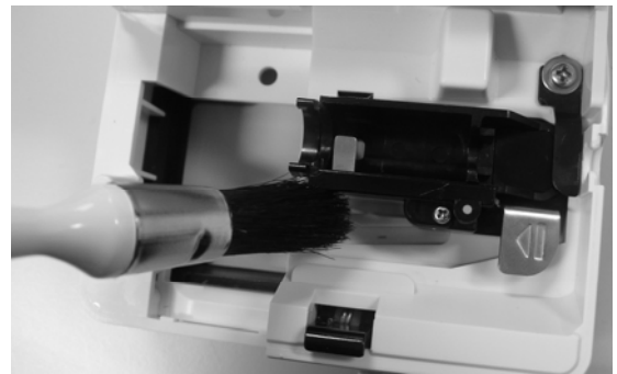
Figure 2 – Utiliser le pinceau pour humidifier la rainure de guidage du chariot
