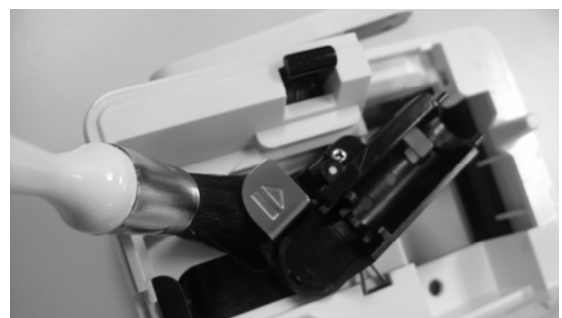
Figure 3 – Utiliser le pinceau pour humidifier la partie arrière de la rainure de guidage du chariot
