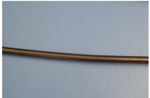
Figure 6 : Câble Moteur intact et non endommagé
