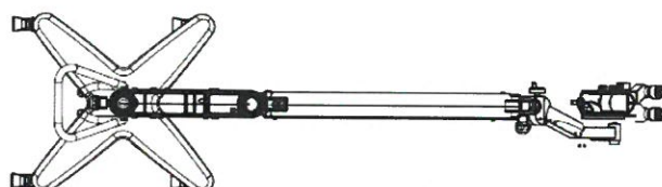
Fig. 3 : Vue de dessus du microscope Leica M525 F20 Positionnement incorrect non prévu : Bras horizontal et bras mobile complètement éployés
