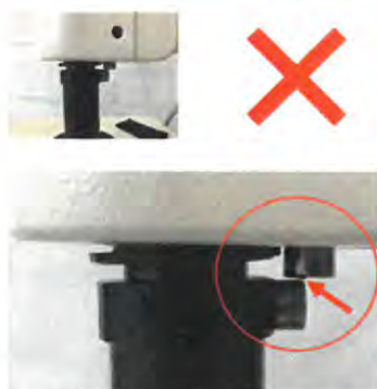
Fig. 4 : Vue détaillée de la vis de butée lorsque le M220 F12 est défectueux : les vis de butée ne sont pas efficaces et autorisent une rotation libre > 360°.
