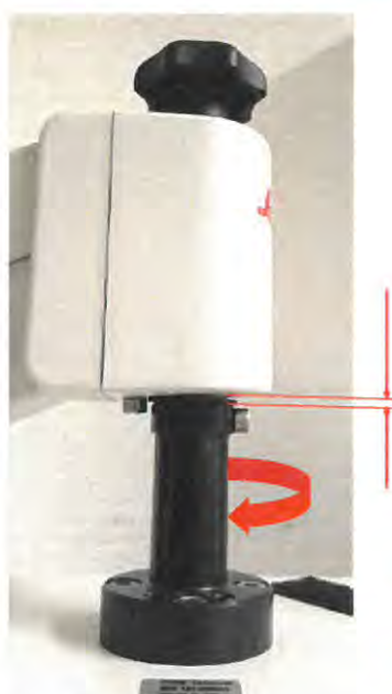
Fig. 3 : Vue détaillée de l'espace entre l'adaptateur noir et le boîtier blanc du bras mobile.
