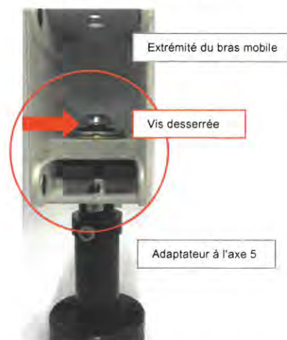
Figure 2 : Vis desserrée connectant le bras mobile au corps de microscope
