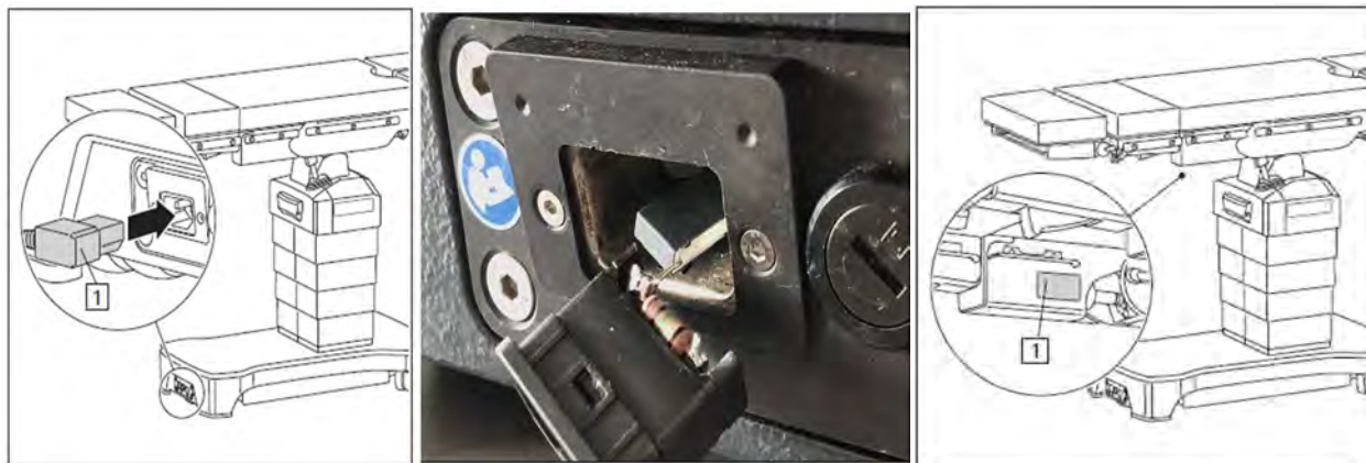
Figure 1 : Position de la prise d'alimentation secteur sur la table d'opération/ Prise d'alimentation arrachée avec composants électroniques exposés/ Position de l'étiquette produit sur la Table d'opération mobile MEERA (avec N° de série)
