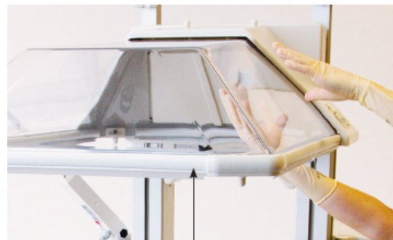
Joint d'étanchéité du capot
