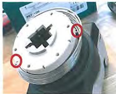
L'enquête indique que le problème ne peut se produire que lors de la fabrication et ne peut se développer au fil du temps. L'utilisateur n'est pas en mesure de déterminer si le ressort a été trop serré.
