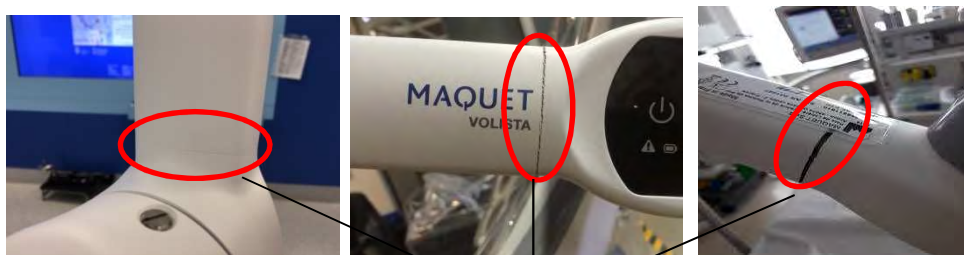
Photos de fissures du revêtement, de différentes tailles
