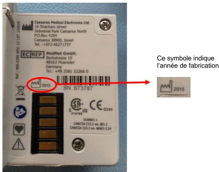
Figure 1 : Emplacement de l'année de fabrication
