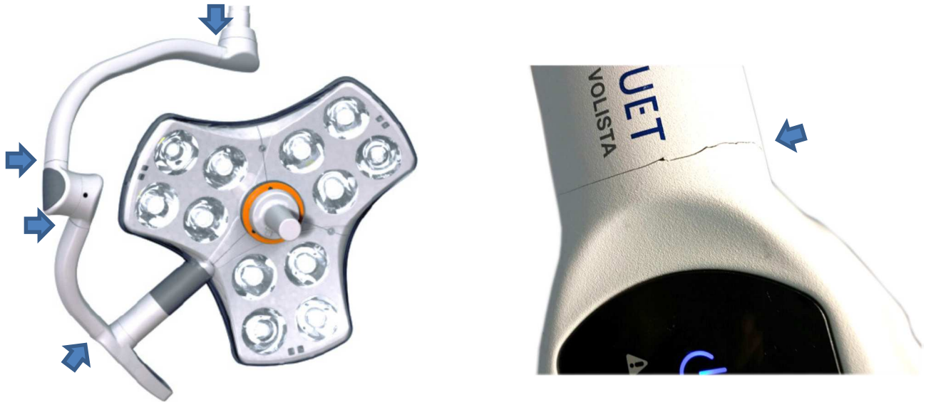
Fig. 1 : Phénomène de fissuration du revêtement
