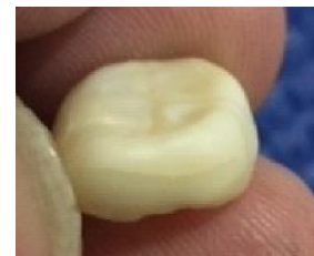
Formation de fissures sur la couronne suite au frittage
