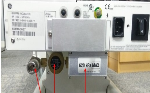
Figure 2 : le module d'oxygène asservi est installé Figure 3 : le module d'oxygène asservi n'est PAS installé
