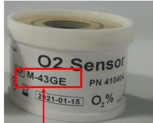
Figure 5 : référence du capteur d'oxygène : 6600-1278-600 Figure 6 : référence du capteur d'oxygène : M-43GE
