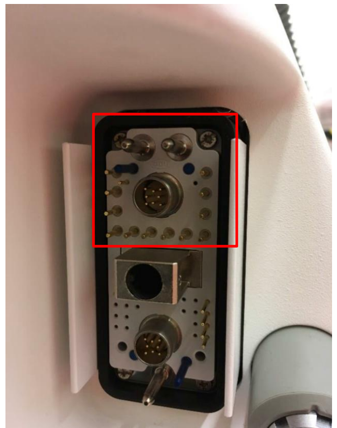
figure 3 : exemple de prise X10 avec zone des broches de contact à ne pas toucher
