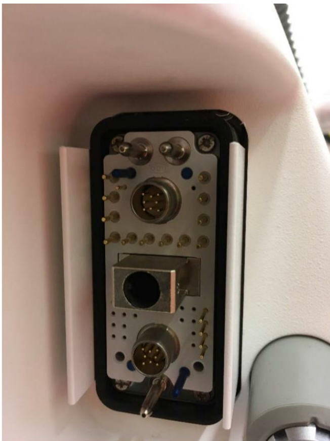
figure 2 : exemple de prise X10 avec fiche du câble principal non branchée
