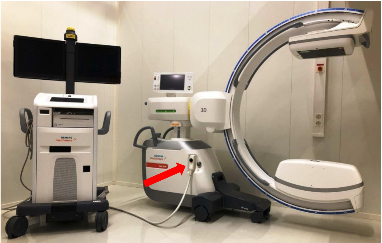
figure 1 : exemple de chariot porte-moniteur raccordé à la prise X10 de l'unité principale (arceau) par le câble principal
