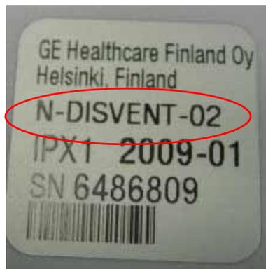
Photo 2. Plaque de signalisation du module N-DISVENT-02. . « N-DISVENT-02 » indique que l'appareil est un module N-DISVENT, version 2 (**unité concernée par le problème**). Si la plaque indique « N-DISVENT-00 » ou « N-DISVENT-01 », l'appareil n'est pas concerné.
