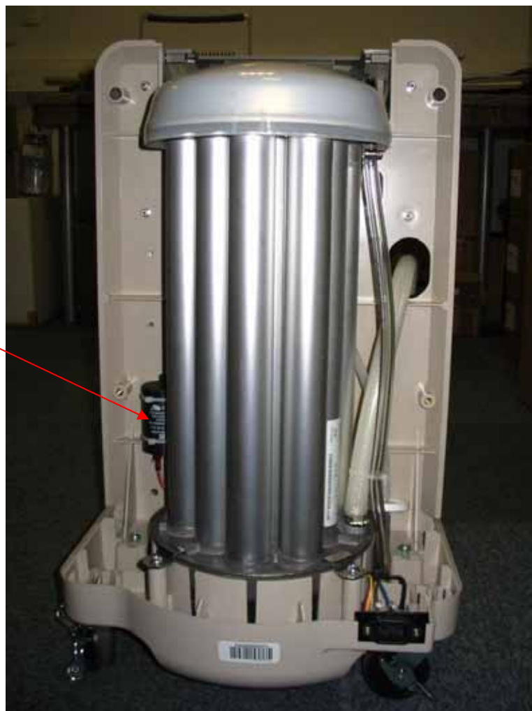
Integra 10EZ équipé du nouveau condensateur
