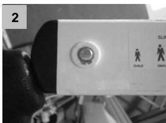
2 Enlever le circlips, la rondelle ainsi que l'axe pour dégager le fléau
