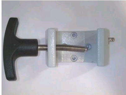
Fig. 2 – Noix de fixation endommagée avec filetage de vis tordu.
