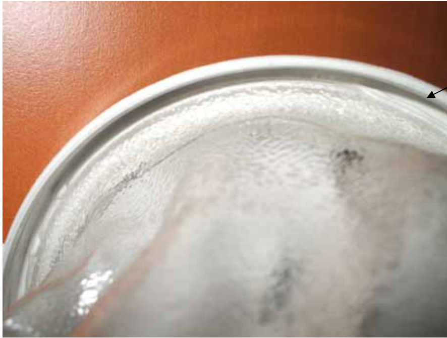
Photo : Image montrant le mauvais alignement du sac avec le couvercle (voir la flèche). En haut le sac est correctement positionné alors que sur la droite il y a un espace.
