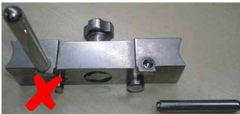
Figure 2: Guide de coupe fémorale distale détérioré – Tige dissociée
