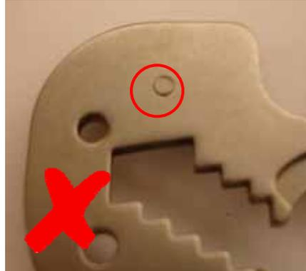
**Figure 6 - Dommages inacceptables de la face arrière du picot**
