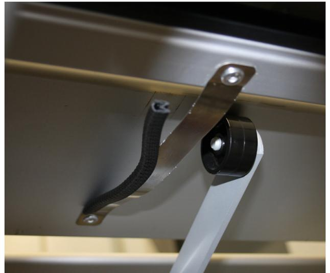
Faites glisser les protecteurs d'arêtes que nous vous avons fournis précautionneusement des deux côtés des courroies de sécurité.
