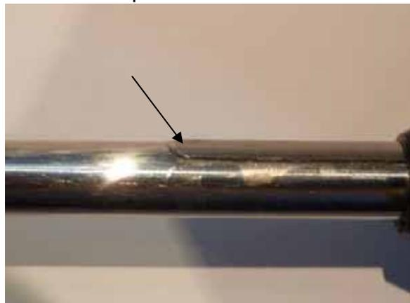
Si l'onglet métallique est absent de l'endoscope, le maintien de la gaine n'est plus parfaitement assuré et l'utilisateur peut alors endommager la lentille de la gaine à usage unique, LW 10030. Dans le cas extrême, la lentille peut casser.
