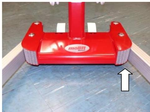
Photo 2 – châssis avec revêtement en mousse gris du mécanisme
