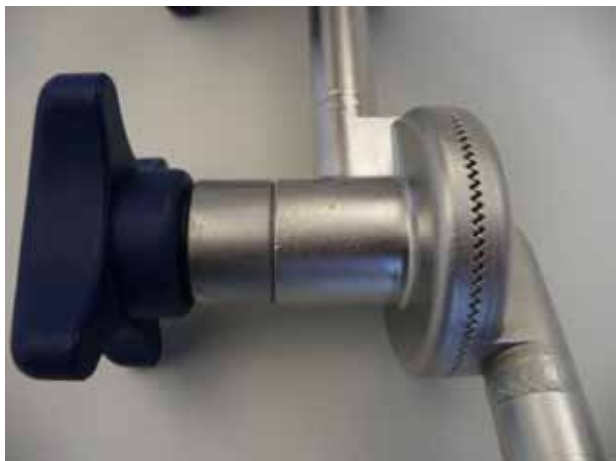
Figure 3 : Poignée en étoile non suffisamment serrée.
