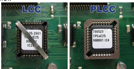
- EPROMs sur les cartes de contrôle -
