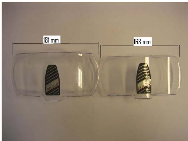
Figure 1 Nouvelle membrane protectrice plus épaisse à gauche ; ancienne membrane protectrice plus fine à droite.
