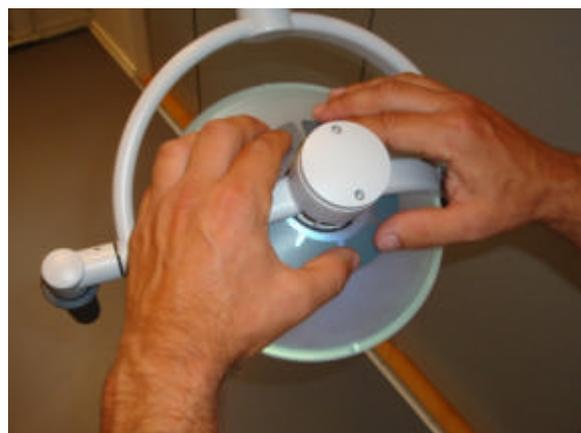
5. Tirer sur la languette pour ôter partiellement le papier de protection légèrement au-delà de la moitié ; positionner le film sous l'arc à nouveau et appuyer dessus tout en retirant le reste du papier de protection du côté opposé.
