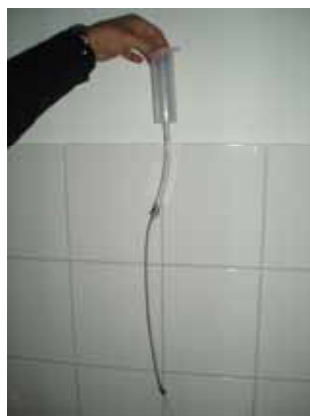
Figure 6: Par gravité 50 ml s'écoulent en environ 60 secondes maximum. Si aucun écoulement ne se produit, merci d'en informer immédiatement Olympus (Tél. : 0 810 142 142 – option 2).
