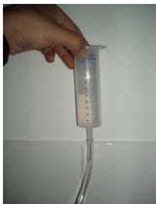
Figure 5: Retirez le piston de la seringue et la remplir de 50 ml d'eau.
