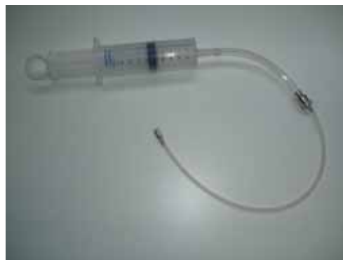
Figure 4: Connectez une seringue de 100 ml via une tubulure en silicone à l'adaptateur via le connecteur métallique (côté marquage laser - connexion à l'ETD 2/mini ETD).
