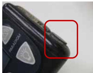
Cache de protection du piston mobile, dépassant du compartiment
