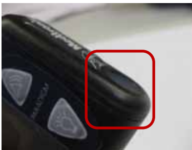
Cache de protection du piston normal , légèrement enfoncé
