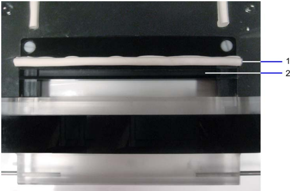
Figure 1. Exemple de joint inférieur correctement installé
