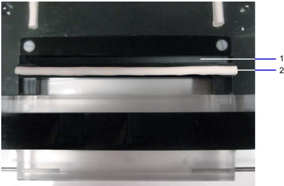
Figure 2. Exemple de joint inférieur incorrectement installé
