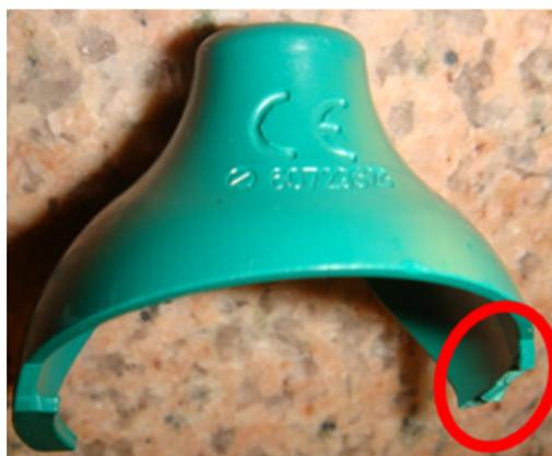
**Fracturation d'onglet typique**
