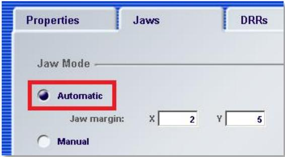
« Jaw Mode : Automatic » est sélectionné par défaut si « Automatically adapted to MLC » est coché dans l'application BPE comme indiqué à l'étape 1 de la présente partie.
