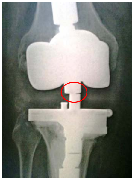
Figure 2. Radiographie montrant la dissociation postopératoire entre la charnière et le montant de la charnière.
