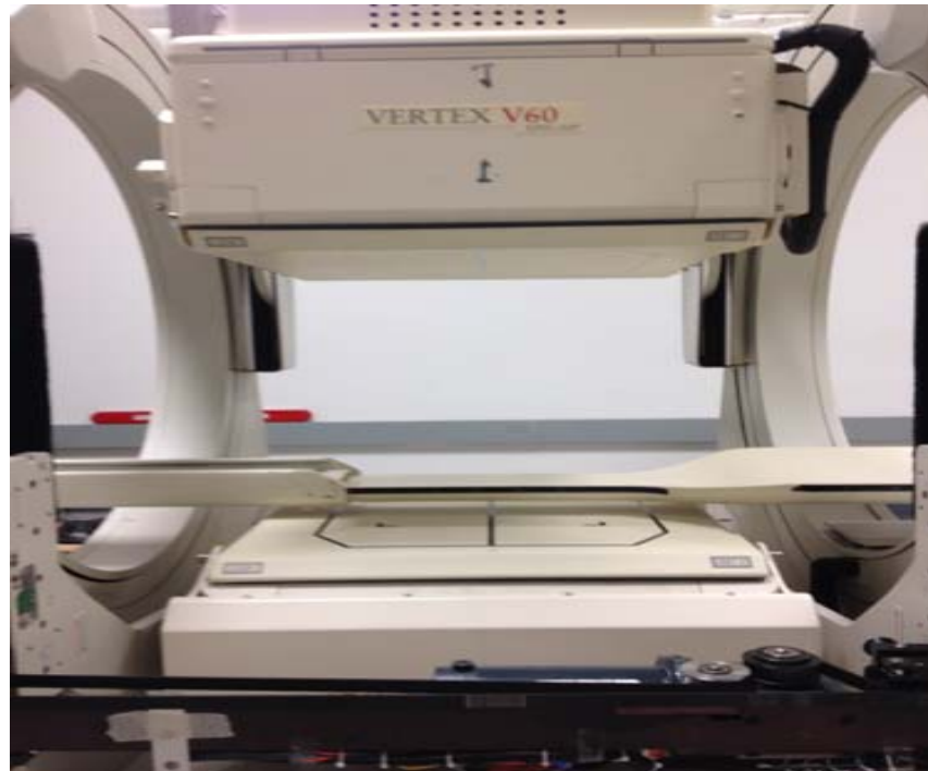
Image 2 : Vue latérale des têtes du détecteur supérieur/inférieur
