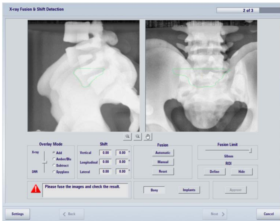
Figure 1. Fusion radiographique - Fusion basée sur les structures osseuses avec la DRR pour déterminer le décalage par rapport à la position souhaitée du patient
