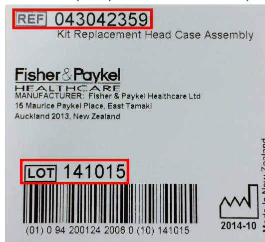
Figure 3 – Numéro de modèle (REF) et numéro de lot (LOT) sur l'étiquette de la pièce détachée
