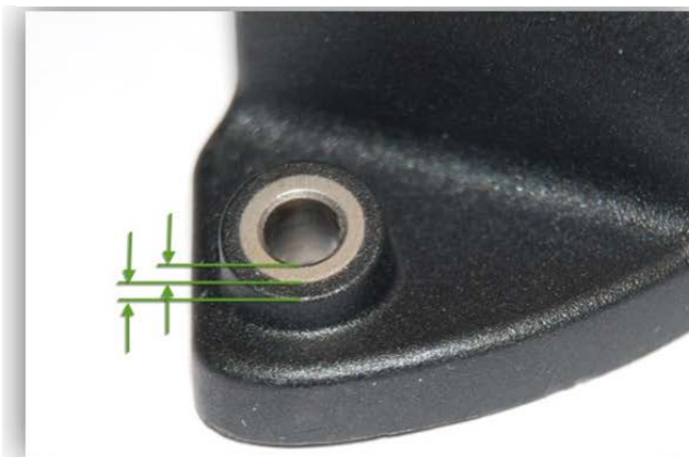
Figure 3 : Surface supérieure du gabarit – comparaison entre un assemblage correct et un assemblage incorrect
