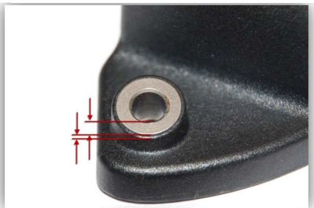
Figure 3 : Surface supérieure du gabarit – comparaison entre un assemblage correct et un assemblage incorrect
