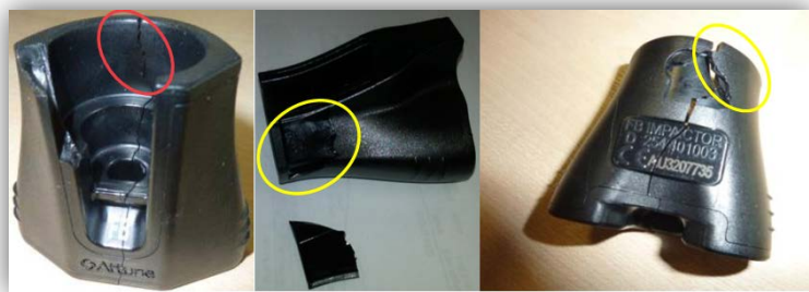
Figure 4 : Rupture des Impacteurs ATTUNE INTUITION™
