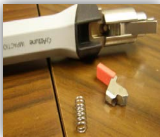
Figure 3 : Rupture d'une Poignée d'Impaction ATTUNE INTUITION™
