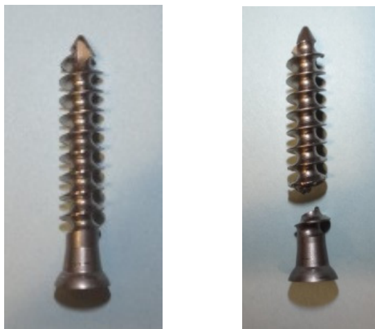
Vis de 35 mm intacte (g) et vis de 35 mm fracturée (d)
