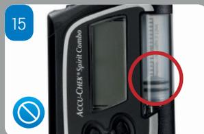
La cartouche est correctement insérée lorsque le piston de la cartouche repose sur le socle de la tige filetée télescopique.
