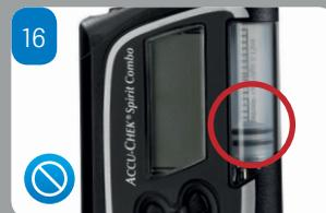
Si le socle de la tige filetée télescopique n'est pas au même niveau que le piston de la cartouche, retirez la cartouche du compartiment et reprenez les étapes 10 à 14.
