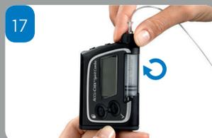
Vérifiez que l'embout luer-lock du dispositif de perfusion est toujours correctement relié à l'adaptateur. Vissez le dispositif de perfusion manuellement et dans le sens des aiguilles d'une montre jusqu'à ce qu'il soit fermement fixé à l'adaptateur.
