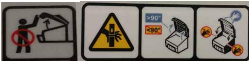
Lors de l'installation de l'automate, une formation est donnée aux utilisateurs, insistant sur le fait que lorsque l'automate est ouvert, le capot principal doit être en position d'ouverture maximale. Lors de l'ouverture et de la fermeture du capot, qui est lourd, il est nécessaire de le maintenir avec les deux mains afin d'éviter une fermeture accidentelle.
