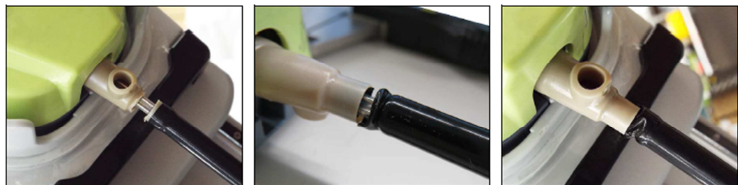
Figure 2. Exemples de ruptures à la jonction entre le mécanisme de rotation et la tige de l'instrument
