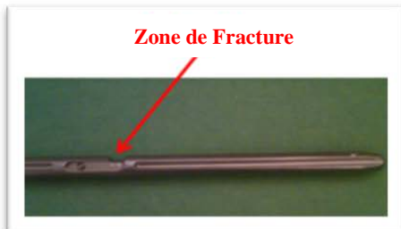
Figure 2 : Zone de fracture potentielle
