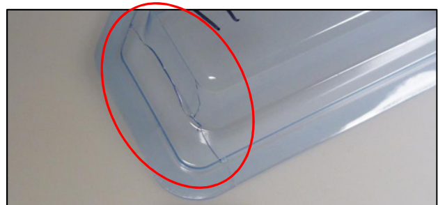
Fig. 2 Barquette extérieure endommagée
