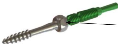
Rupture de la vis entre la tête de vis et l'extension filetée
