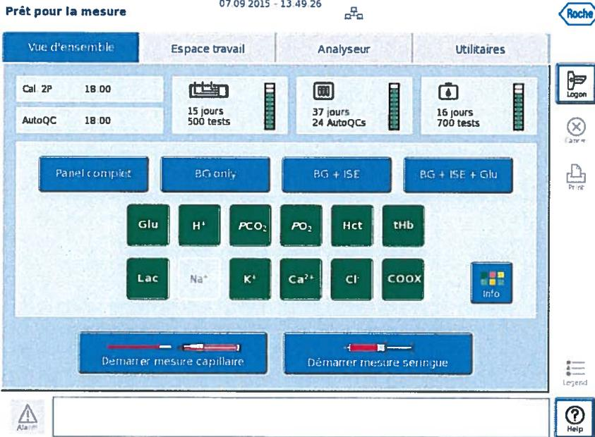
Avant l'installation d'un nouveau Sensor Cartridge non affecté, réactivez le paramètre  $Na^+$ :
